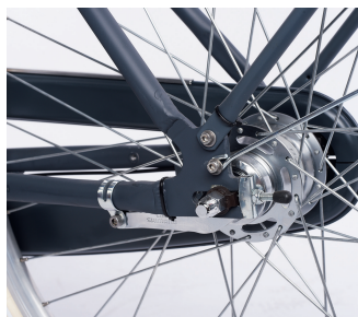
Details: Frontlicht unterm Fronträger, V-Bremsen, Starrgabel. Unten: Gekapselte 7-Gang Nabenschaltung, dahinter der Kettenkasten.
